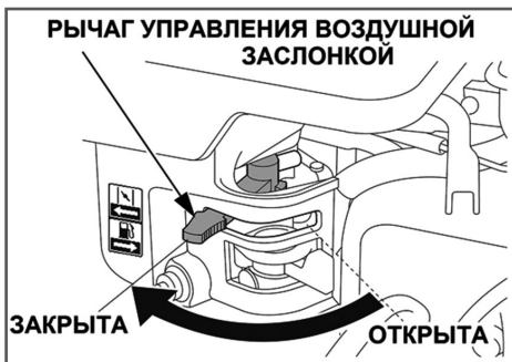
Рис. 9 Воздушная заслонка закрыта
