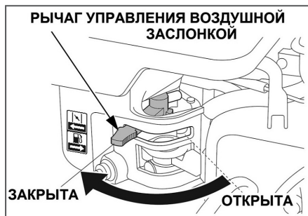
Рис. 7 Рычаг управления воздушной заслонкой
