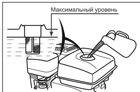
Рис. 6 Максимальный уровень топлива в топливном баке
