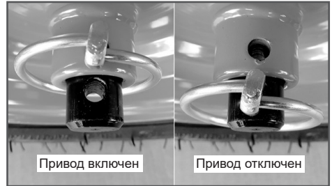
Рис.10 Перестановка шплинта на левом колесе
