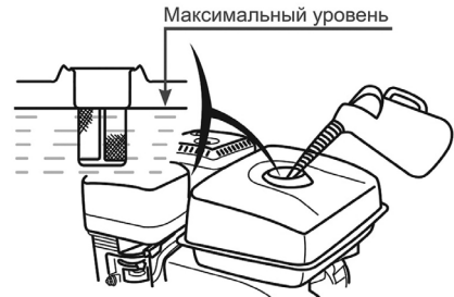
Рис. 6 Максимальный уровень топлива в топливном баке
