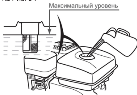
Рис. 9 Максимальный уровень топлива в топливном баке
